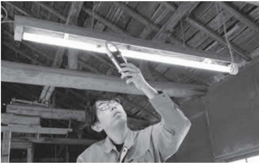
写真4 クランプメータの使用事例
