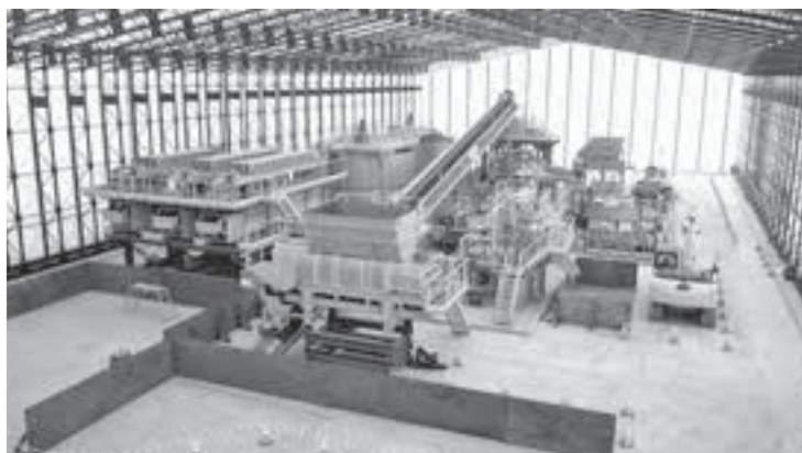
中間貯蔵施設内における 除去土壌の分級処理システム実証試験
